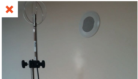
1,6 m/s à proximité du lit d'un internat, qui n'est plus utilisé en raison de l'inconfort. ©AQC
