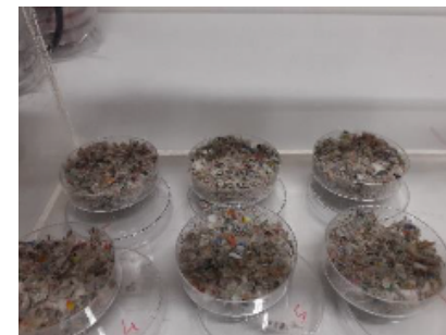
Échantillons de ouate de cellulose ensemencés et incubés. Source : IMT Atlantique
