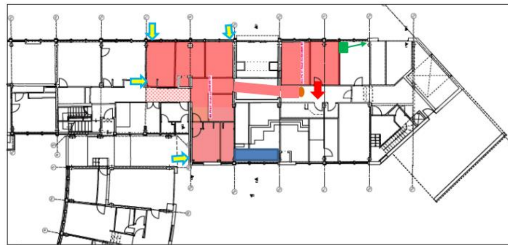
DÉSAMIANTAGE DES SOLS - RDC - Bâtiments A' A - PHASE 1 - échelle 1/200
