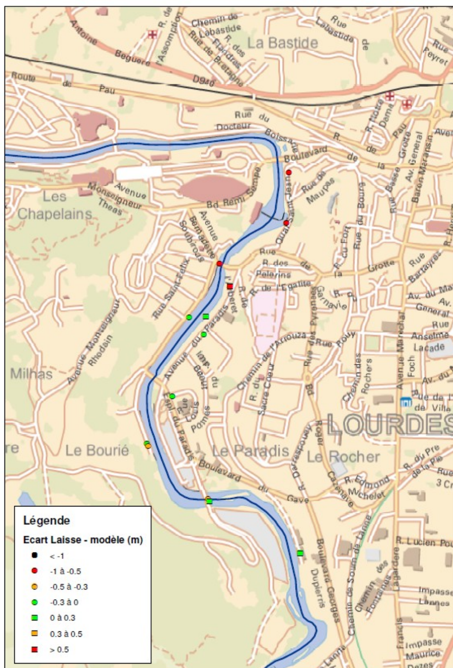
Illustration 24: Calage du modèle sur les laisses d'octobre 2012
