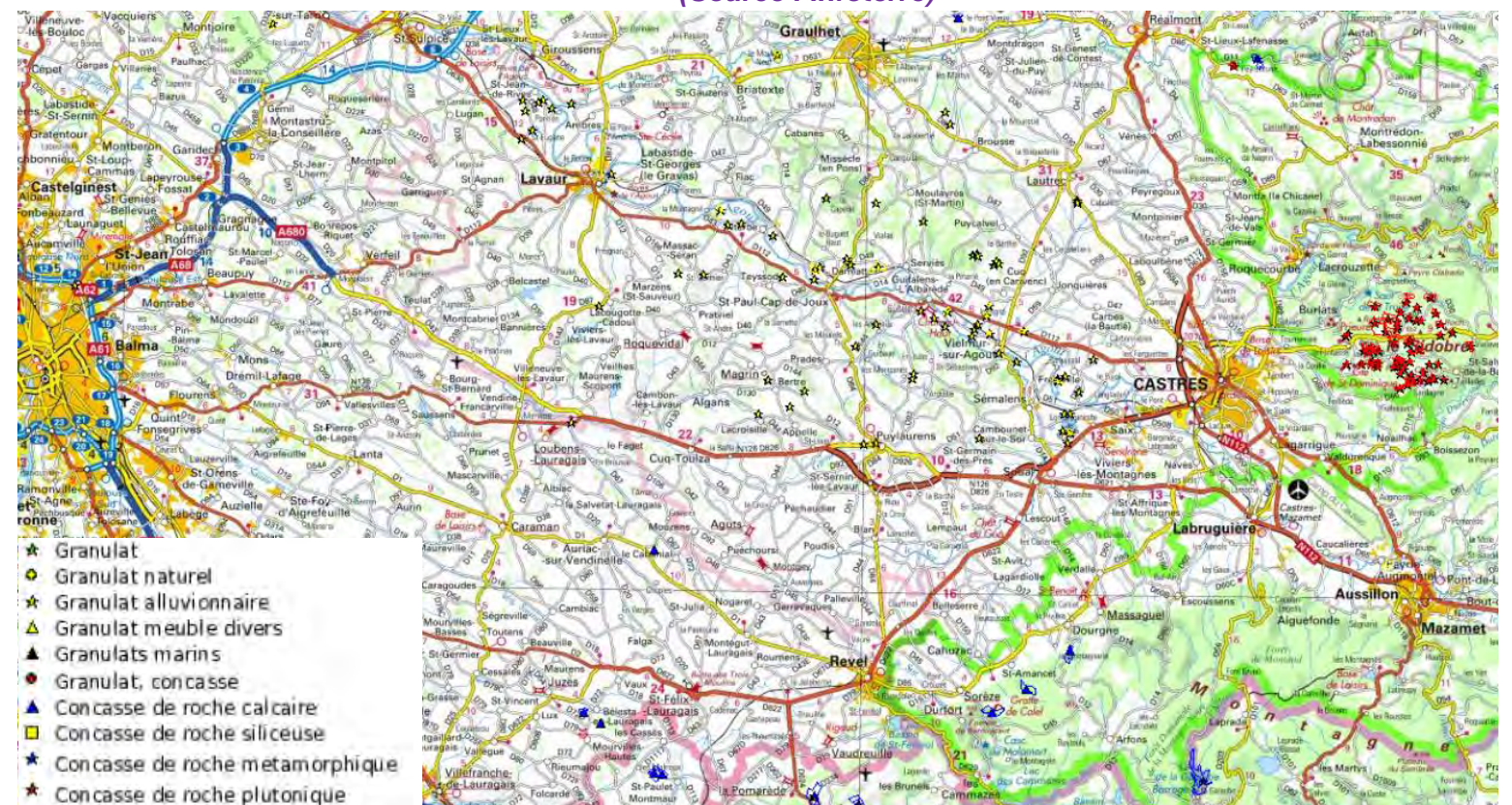
Figure 55 : Localisation des sites d'extraction entre Toulouse et Castres-Mazamet (Source : Infoterre)
