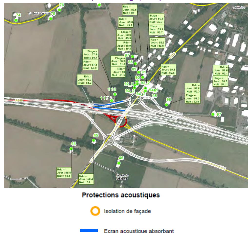
Figure 4 : Localisation des protections à mettre en place à l'entrée de Verfeil (Source : Egis, 2015)
