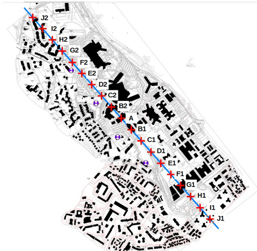
Illustration 4: Modélisation de la zone avec emplacements des sources et points de réception
