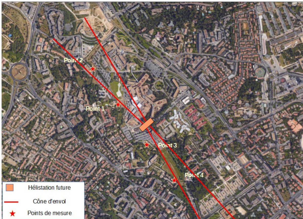
Illustration 2: Plan de situation et points de mesure de l'hélistation future
