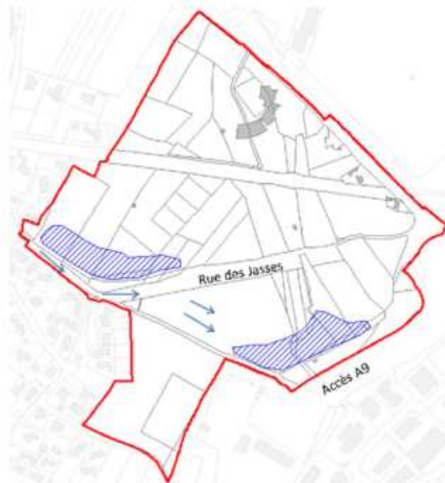
Illustration n°12 : Zones d'accumulation des eaux pluviales issues des enquêtes de terrain
