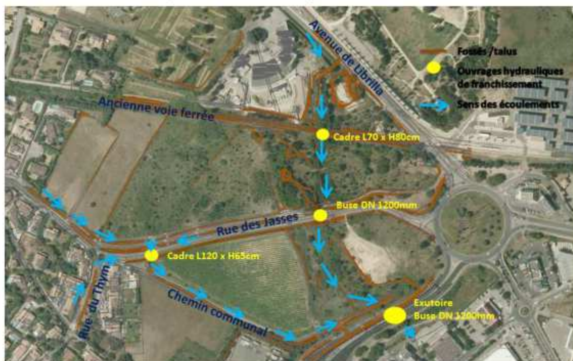
Illustration 8 : Axes d'écoulement du réseau pluvial actuel du quartier des Jasses
