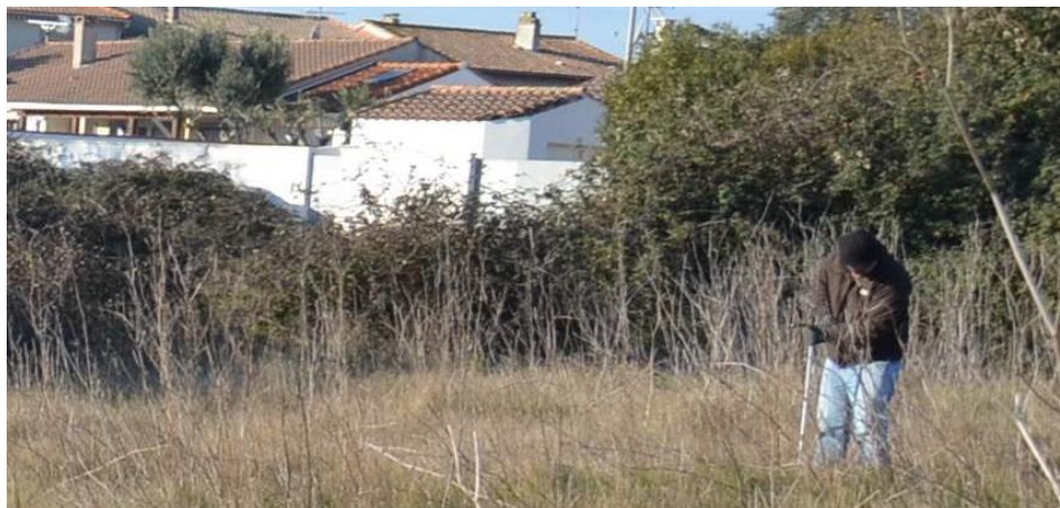
Photographie 16 : Réalisation d'un sondage pédologique à la tarière manuelle
